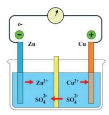
Si se acaba el Zn o el Cu2+, no puede producirse la oxidación o la reducción. Esto es lo que ocurre cuando se "gasta" una pila. Si se abre el circuito electrónico, no puede producirse la corriente electrónica. Es lo que ocurre cuando apagamos el aparato eléctrico que "funciona a pilas"
